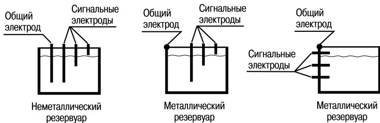
Рисунок 5.4 – Примеры установки кондуктометрических зондов
