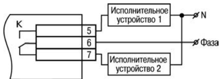
Рисунок Б.4 – Схема подключения нагрузки к ВУ типа Р
