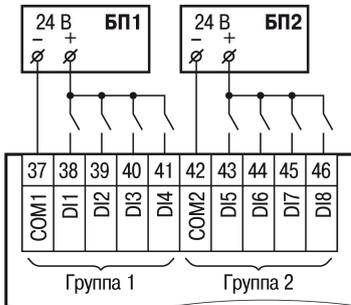
Рисунок 5 – Подключение дискретных датчиков с питанием 24 В
