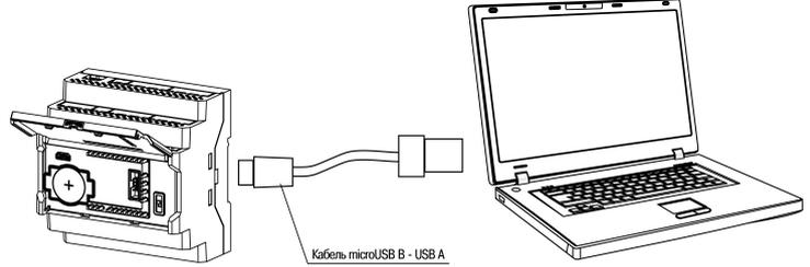
Рисунок 11 – Подключение к ПК (крышка открыта)
