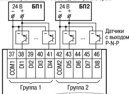
Рисунок 7 – Подключение датчиков с выходным транзистором р-п-р-типа
