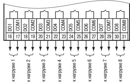
Рисунок 10 – Схема подключения нагрузки к ВЭ типа Р
