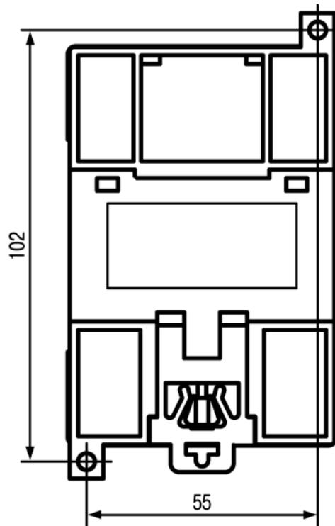
Рисунок А.2 – Установочный чертеж МК110
