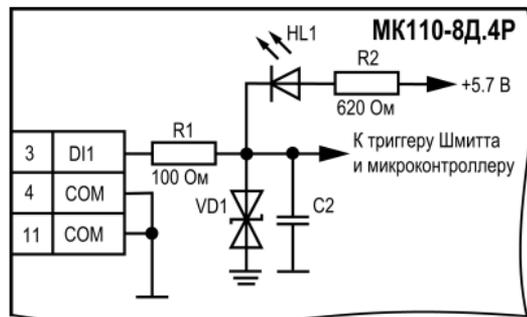
**Рисунок Б.8 – Электрическая принципиальная схема входа МК110-8ДН.4P (схема других входов идентична приведенной)**
