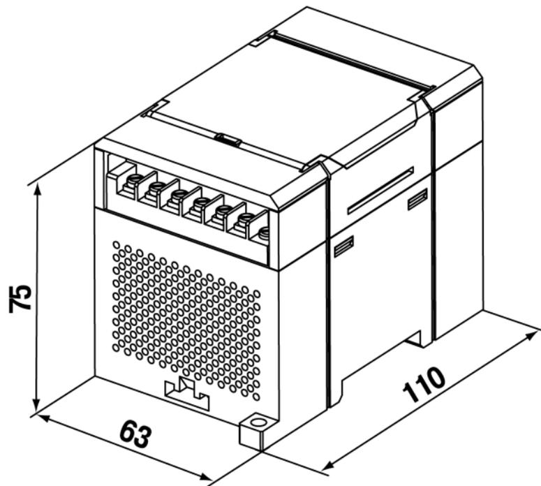
Рисунок А.1 – Габаритный чертеж МК110
