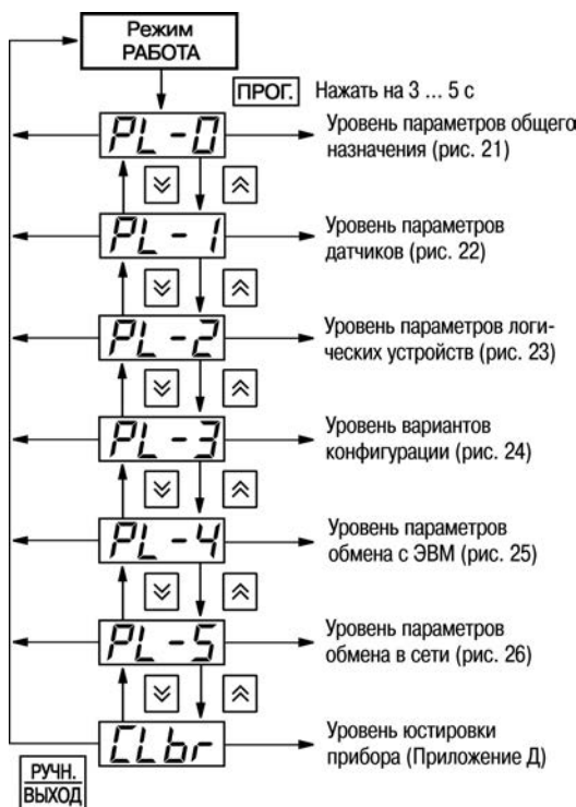
Рисунок 6.1 – Схема выбора уровня программируемых параметров
