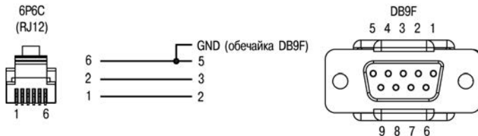
Рисунок В.5 – Кабель KC2 для подключения ПЛК154 к панелям ИП320, СП270 и СП3хх (порт RS-232 Debug)
