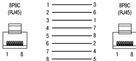
Рисунок В.7 – Кабель Ethernet crossover
